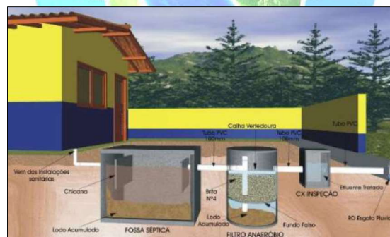
Figura 69 – Tanque séptico + filtro anaeróbio + sumidouro
